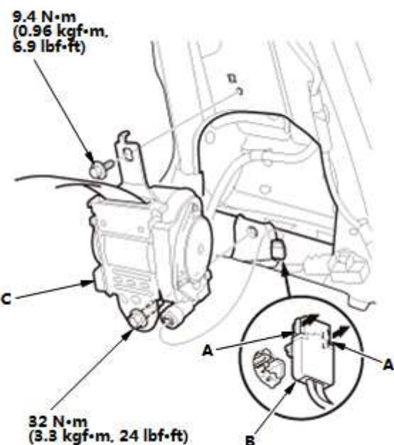
1. 拉起两个锁止凸舌 (A) 以断开插接器 (B)。
